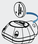
3. 用合适工具将仓盖顺时针旋转装入指拨模块
